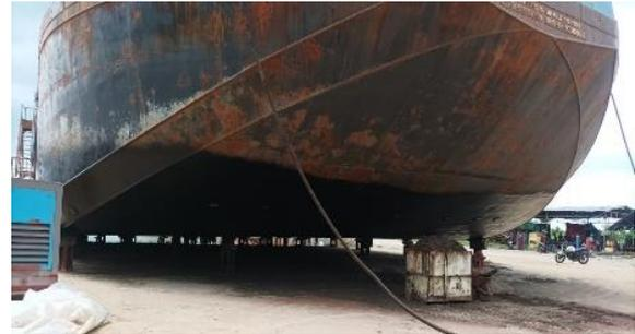
**Gambar 9.** Pengecatan Lapisan Kedua
