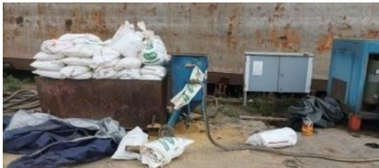
Gambar 4. Persiapan Peralatan *Sandblasting*
