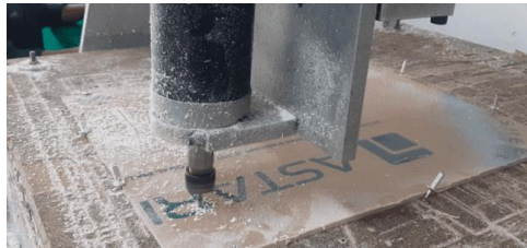
Gambar 2. Pemotongan Frame dengan CNC
