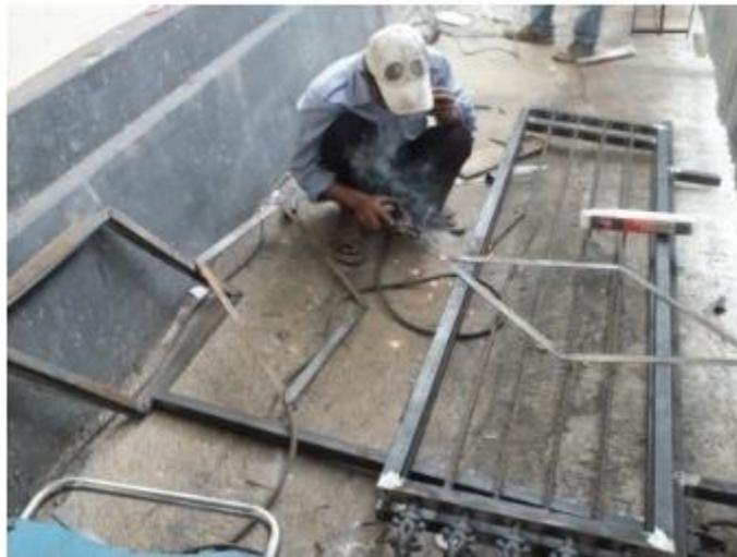
Gambar 3 Proses Pengelasan
