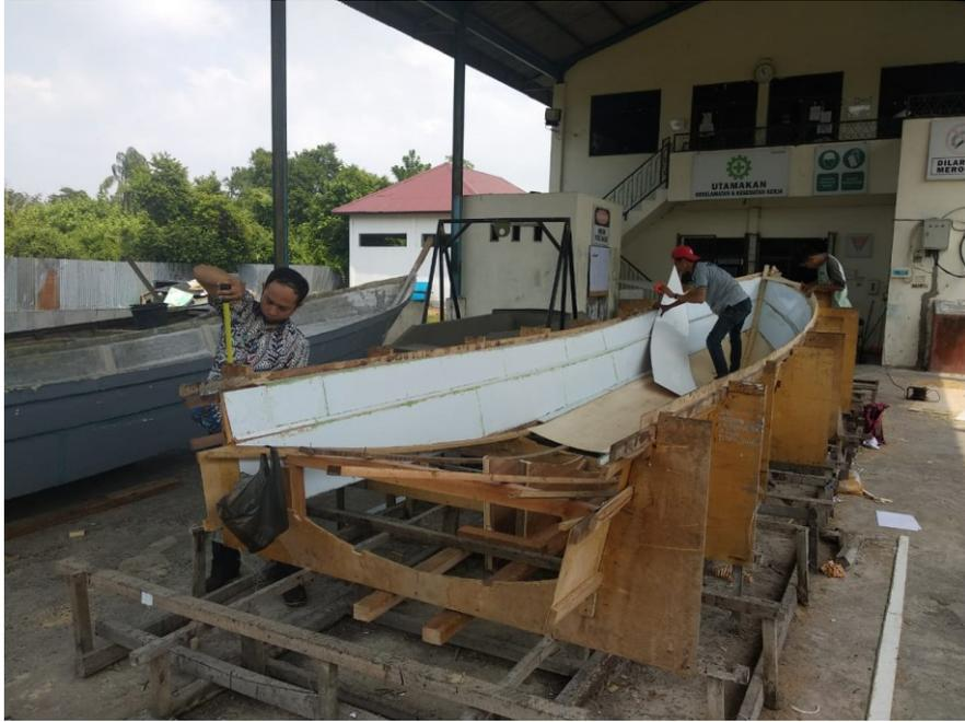
Gambar 2. Pengukuran Tinggi Kapal buritan Kapal 2 GT
