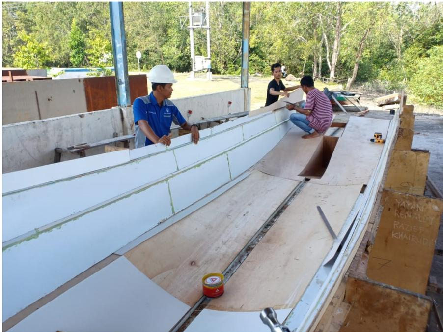
Gambar 4. Pemasangan triplek mika pada cetakan
