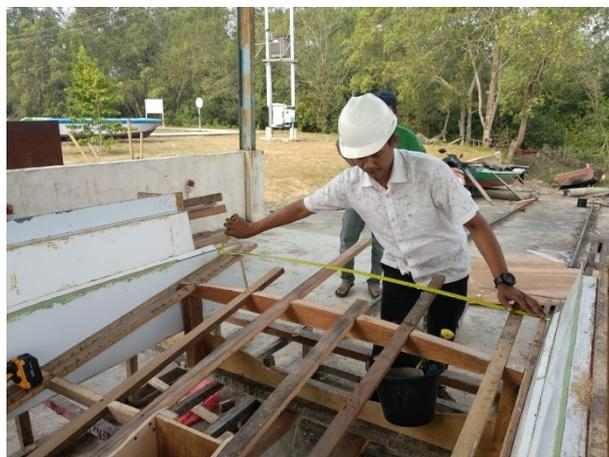
Gambar 1. Pengukuran dimensi cetakan kapal fiberglass 2 GT pada bagian Buritan Dinas Perikanan Kota Dumai
