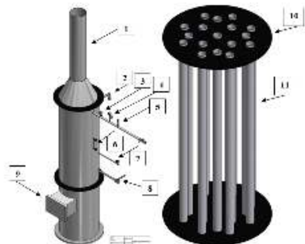
Gambar 3.1 Desain boiler vertikal firetube Sumber: Desain pribadi
