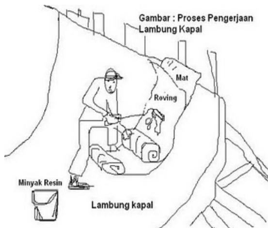
Gambar 4. Proses Pemasangan Mett dan Wr
