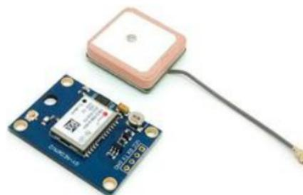
Gambar 4. Modul GPS NEO-6M
