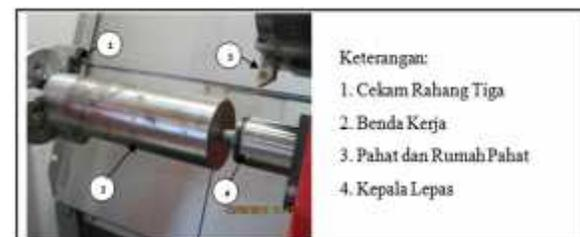
Gambar 11. Setup Peralatan
