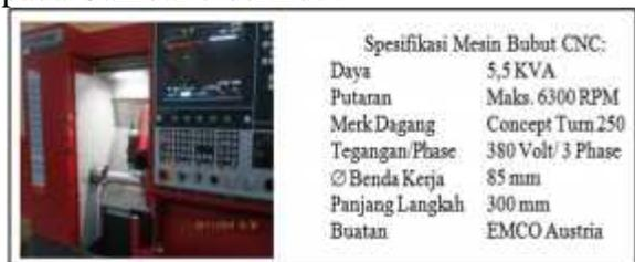
Gambar 7. Mesin Bubut CNC
