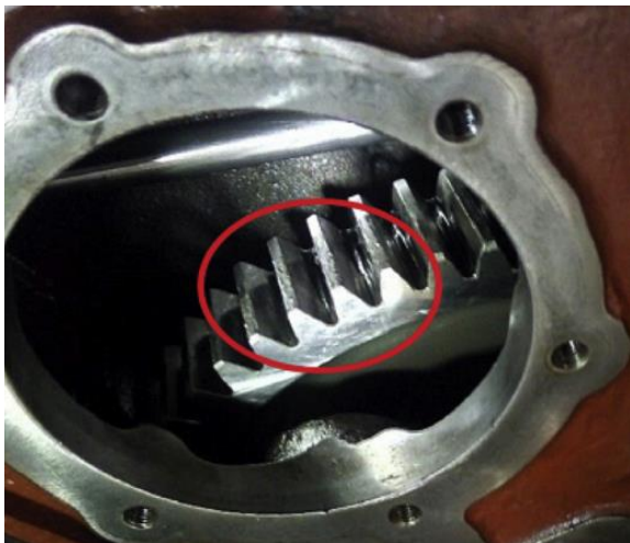
Gambar 3. Roda Gigi Penggerak yang Rusak
