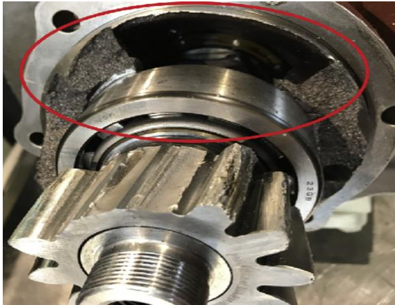
Gambar 2. Kerusakan Bracket pada Pompa
