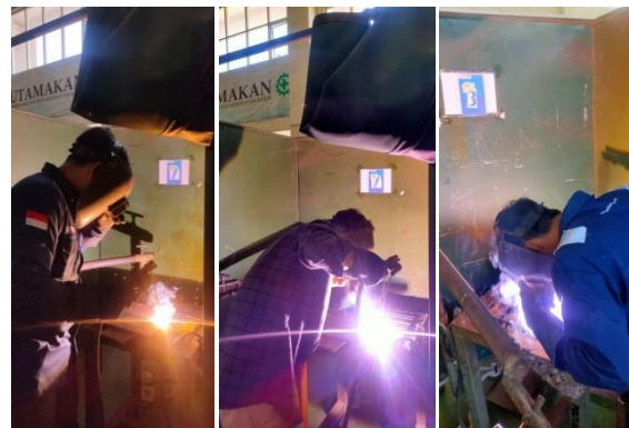
Gambar 4. Pengelasan posisi 1G dengan proses SMAW oleh ketiga mahasiswa sebelum menggunakan mesin las AR
