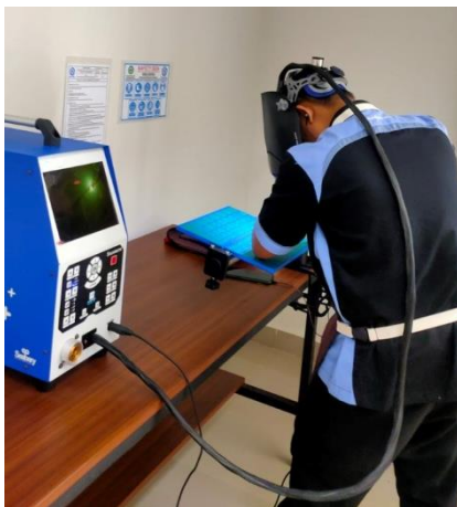
Gambar 1. Mesin las berteknologi AR
