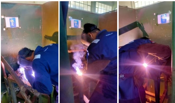
Gambar 6. Pengelasan posisi 1G dengan proses SMAW oleh ketiga mahasiswa setelah menggunakan mesin las AR
