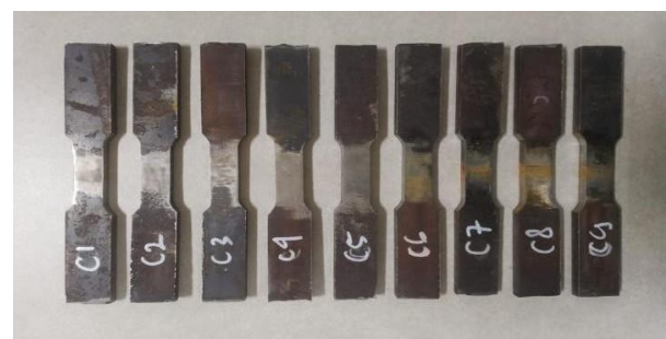
Gambar 7. Sejumlah spesimen tensile test pada satu variasi heat input
