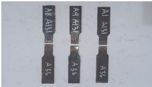
Gambar 9. Spesimen uji yang “rejected” patah pada weld metal
