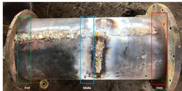
Gambar 4 . Daerah kontak pada stern tube poros propeller
