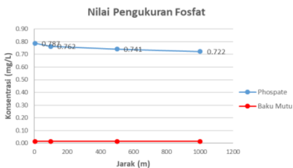
Gambar 5. Hasil Pengukuran Lapangan Fosfat
