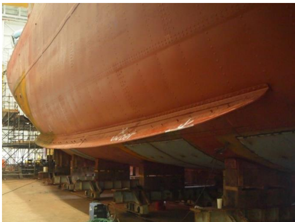
Gambar 2 Teknologi Bilge keel pada kapal modern [5]
