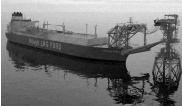
Gambar 2. Hoegh LNG FSRU dengan Tower yoke Mooring System . [4]
