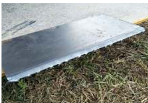
Gambar 1. Material dipotong dengan sudut 30°
