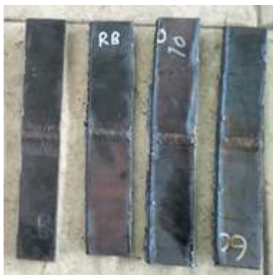
Gambar 5. Hasil pemotongan spesimen Elektroda
