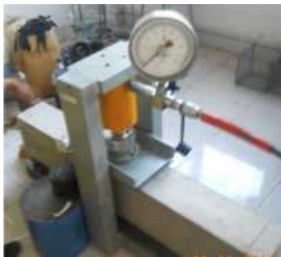
Gambar 9. Uji lentur balok (BO)
