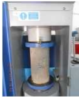
Gambar 8. Uji Tekan Beton
