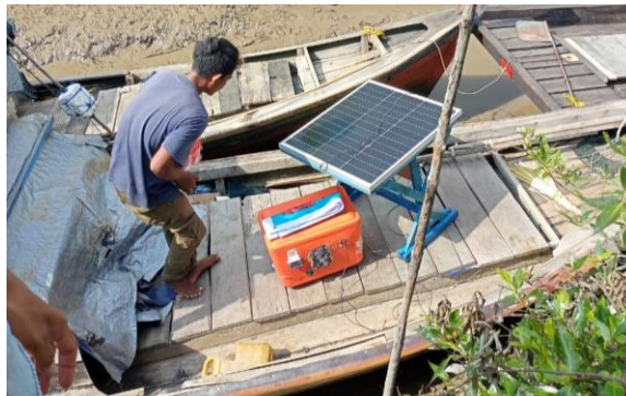
Gambar 3.4. Pemasangan Cool box portable ke kapal Nelayan
