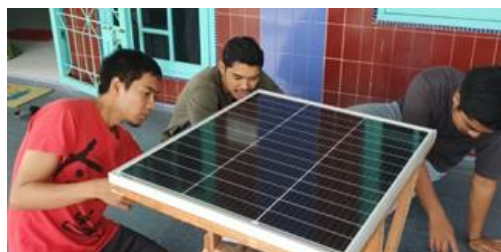
Gambar 3.2. Proses perakitan sistem cool box dari panel surya ke baterai kemudian ke Peltier
