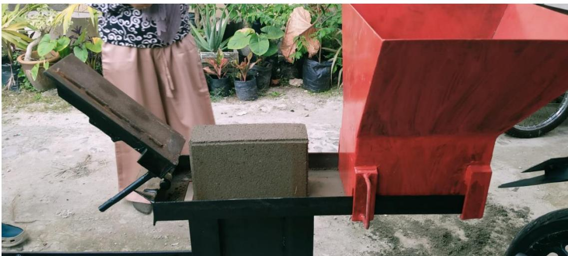
Gambar 6 Pengujian Alat Cetak Paving Block
