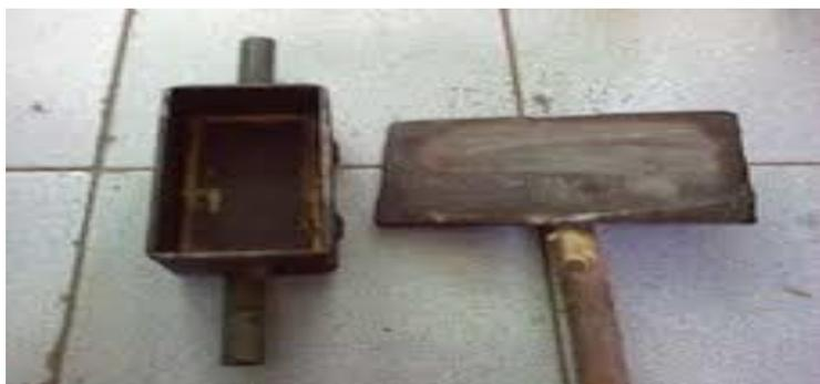
Gambar 1. Alat cetak paving block manual
