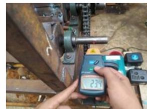
**Gambar 4.4** Hasil pengukuran menggunakan tacometer
