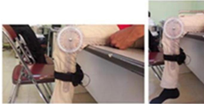
Gambar 6. Pemasangan Sensor *Gyroscope* dan Goniometer
