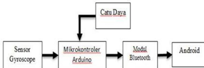
Gambar 2. Diagram Blok Keseluruhan Alat
