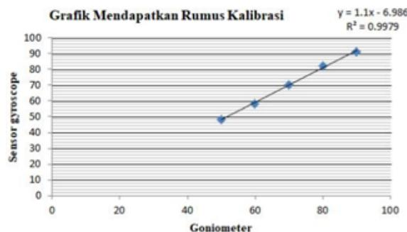
Gambar 5. Grafik Persamaan Goniometer dan Sensor Gyroscope MPU 6050
