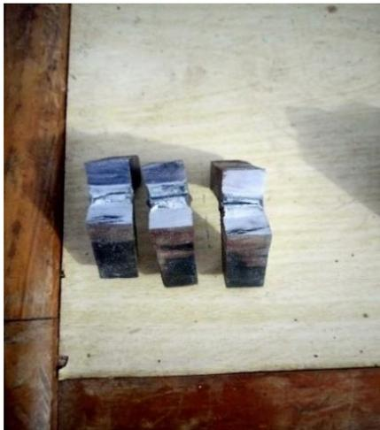
**Gambar 5.** Hasil Uji Spesimen Elektroda A
