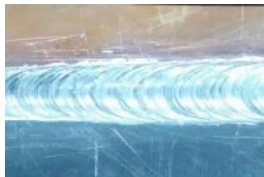
Gambar 4. Hasil Sambungan Las Linier-Shaped
