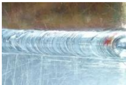
Gambar 6. Hasil Sambungan Las Saw-Shaped
