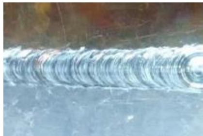
Gambar 5. Hasil Sambungan Las Tooth-Shaped
