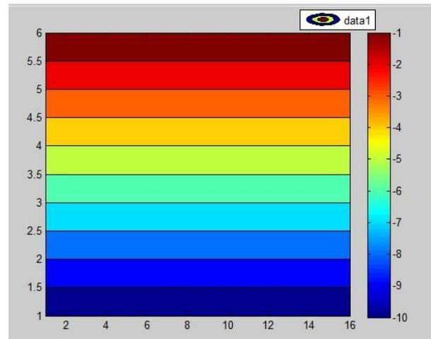
**Gambar 3.** Bentuk Contour fungsi aliran pada pipa lurus
