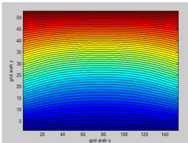
**Gambar 6.** Bentuk Contour kecepatan saluran pipa lurus
