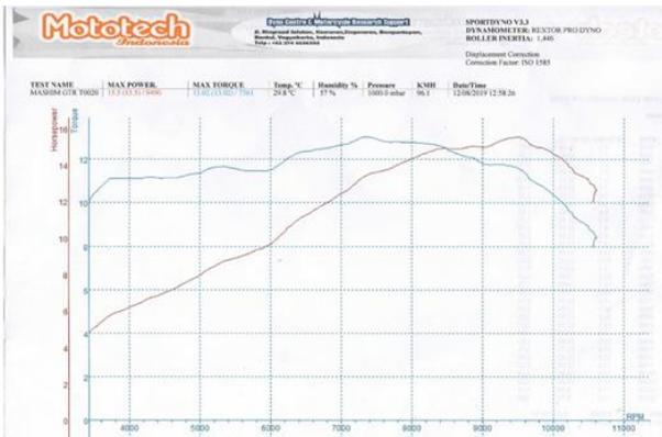
Gambar 9. Data Pengujian Dynotest Engine pada Voltase 13.5 V
