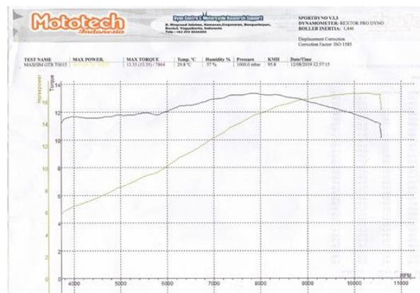
**Gambar 7.** Data Pengujian *Dynotest Engine* pada Voltase 12.5 V
